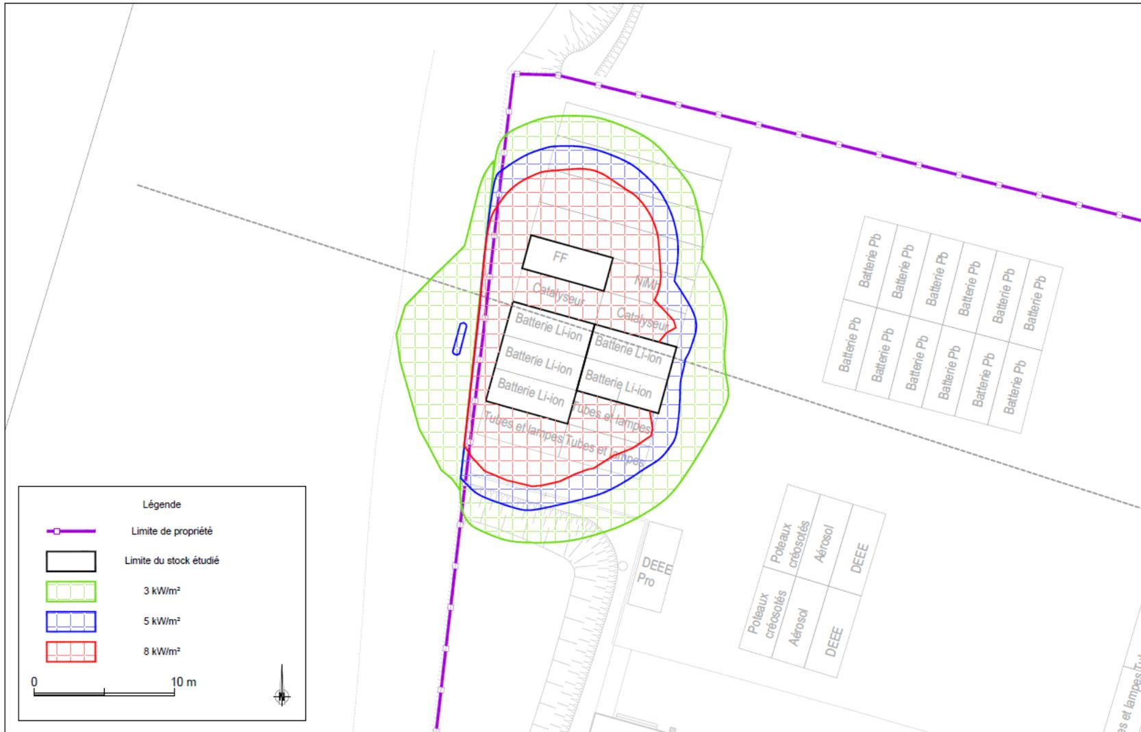
Figure 10 : Cartographie des effets thermiques – Incendie généralisé de l’ilot de 5 containers de batteries Li-ion et du container de fluides frigorigènes
