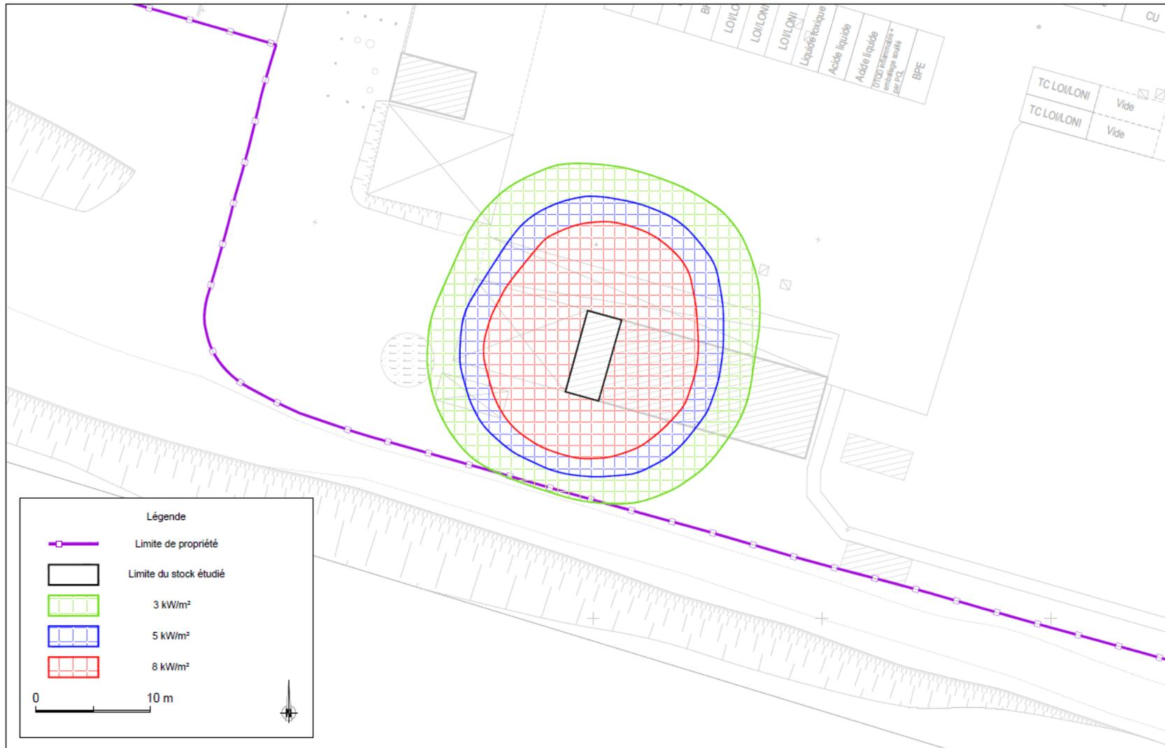
Figure 9 : Cartographie des effets thermiques – PhD7 Incendie de l'alvéole couverte n°5
