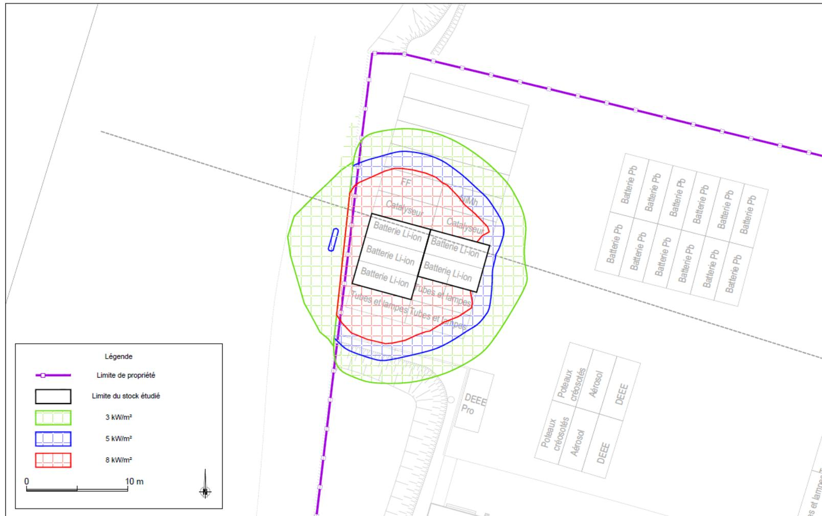
Figure 2 : Cartographie des effets thermiques – PhD3.3 Incendie généralisé de l'îlot de 5 containers de batteries Li-ion
