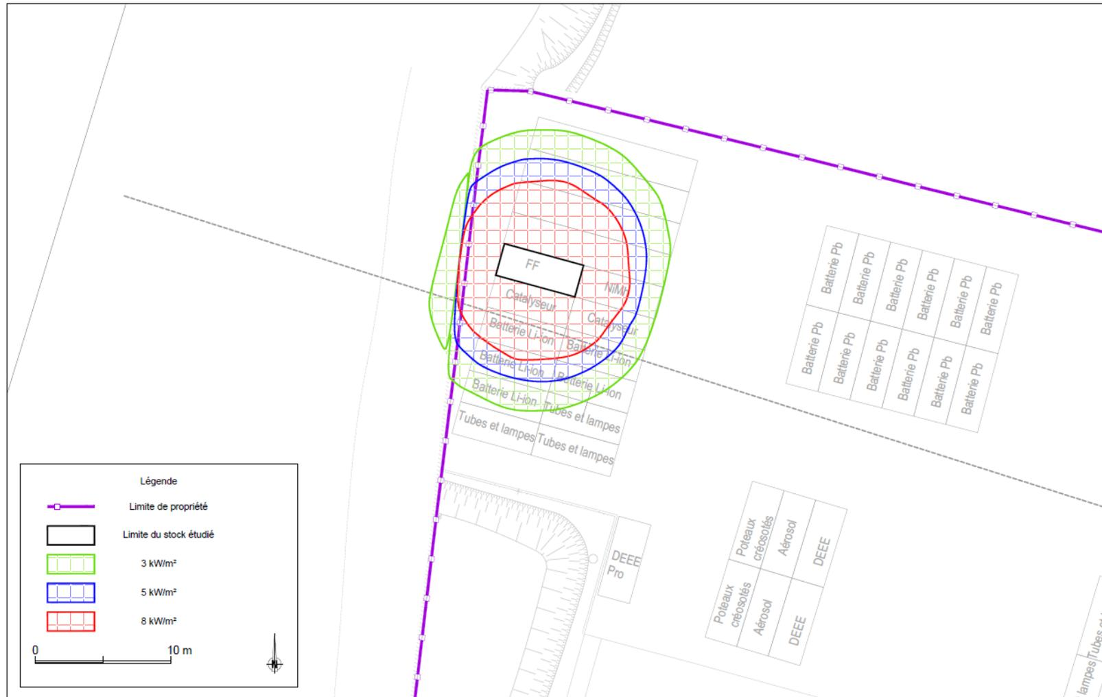
Figure 3 : Cartographie des effets thermiques – PhD3.4 Incendie du container de fluides frigorigènes
